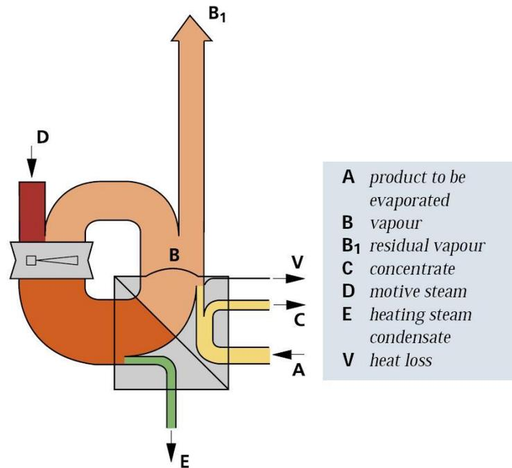
**Figure 3.17. Thermal vapour recompression (GEA, 2013)**
