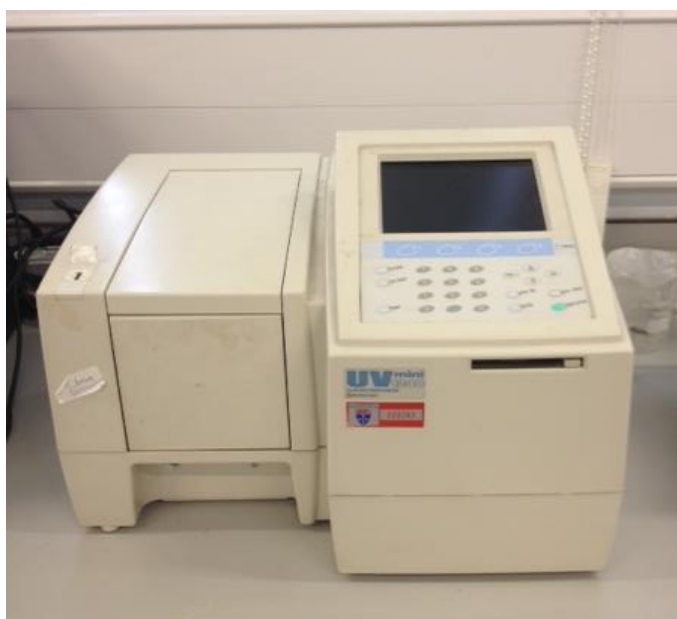
Figure 2.10. Photograph of the Shimadzu 1240 mini UV-Vis spectrophotometer.
