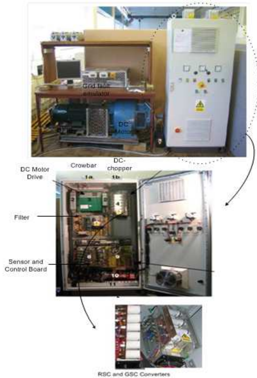
Fig. 4.1 DFIG test rig
