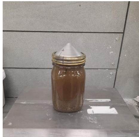
(d) Pycnometer + saturated & surface dry sharp sand + water
