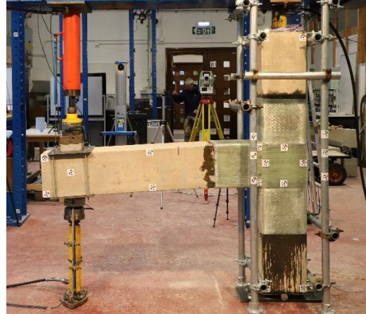
(d) Drift ratio: 3.85%, Displacement: 50 mm
